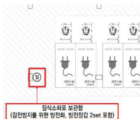
질식소화포 설치 예시
