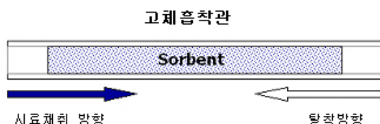
그림 2. 고체흡착관의 시료채취방향과 열탈착방향
